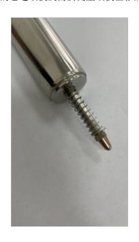
多点位移计宜布置在近坝区岩体、高边坡和滑坡体的断层、裂隙、夹层层面出露的边坡坡面和坝基上,以及地下洞室围岩顶部和边墙两侧。仪器可在水平、垂直或任意方向的钻孔中安装埋设,水平孔宜向下倾斜5~10度,以便于灌浆和确保较深处锚头的浆液密实。多点位移计的组成及工作原理: 1、多点位移计主要由锚头、传递杆、护管、支承架、传感器、护罩以及灌浆管组成。2、原理:在钻孔内不同深度的锚头用灌浆或液压锚固的方法与孔壁锚固为一体,当围岩沿钻孔轴线方向发生位移时,其位移量就通过与锚头联结在一起的钢杆(或钢丝)传递到孔口的传感器上,得出与位移成比例的电压或频率变化,并在显示器上显示,然后,可将电测信号换算成位移量。北京数字式顶出位移计行情振弦式多点位移计主要由位移传感器及护管、不锈钢测杆及PVC护管、安装基座、护管连接座、锚头、护罩。
