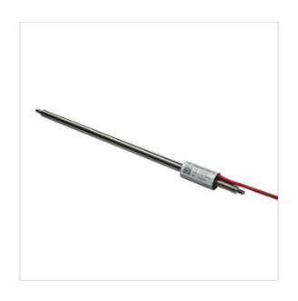
位移计即裂缝计等振弦式仪器在监测时,都会或多或少的受到温度的影响,因此我们在监测位移变化的时候,都会尽可能规避温度的影响,因为就位移计计算来说,位移计的计算公式成立前提是,不考虑外界温度变化的。位移计在受到轴向位移变形,其变形位移量和频率模数组成的计算公式如下 $\Box$ J=K $\triangle$ F $\Box$ \DeltaF=F-F0 $\Box$ 位移计计算公式中 $\Box$ J是位移计监测的变形量 $\Box$ \DeltaF是输出的频率模数 $\Box$ k是标定系数,单位为mm/KHz2 $\Box$ \DeltaF是裂缝计实时测量值相对于基准值的变化量 $\Box$ F是裂缝计的实时测量值 $\Box$ F0是裂缝计的基准值 $\Box$ \DeltaF $\Box$ F $\Box$ FO=个数值的单位皆是KHz2 $\Box$
